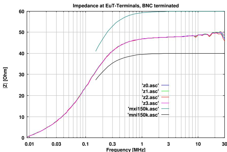
**Abb. 5: Impedanz an den Prüflingsklemmen), BNC mit 50 Ω Abschluss**
