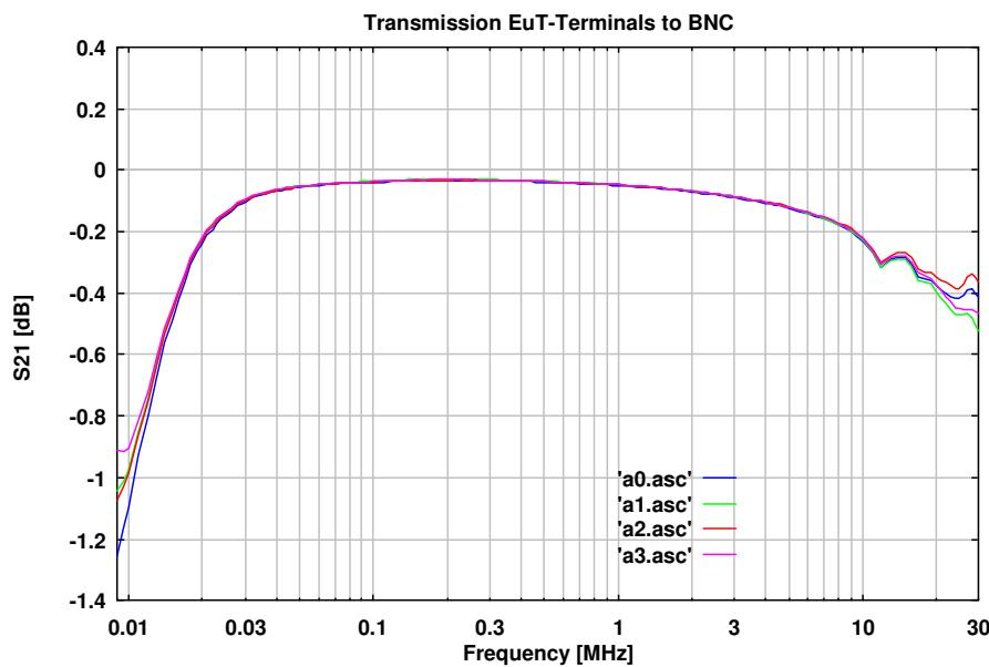
**Abb. 4: Transmission Prüflingsklemmen - BNC**
