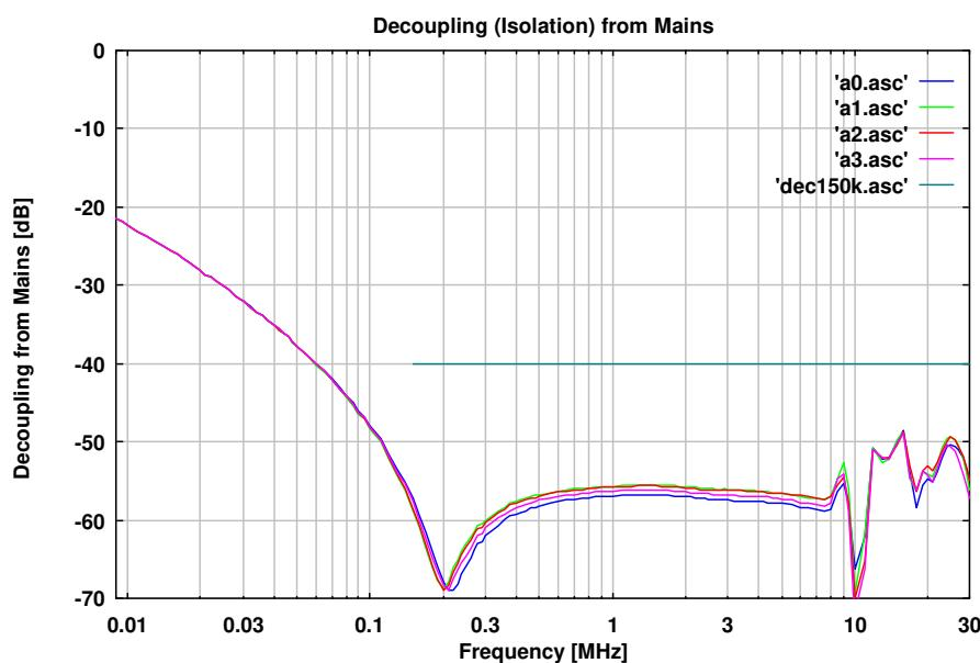
Abb. 7: Entkopplung vom Speisenetz, BNC mit  $50 \Omega$  Abschluss
