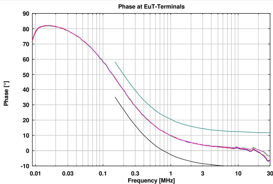
Abb. 6 Phase an den Prüflingsklemmen, BNC mit  $50 \Omega$  Abschluss
